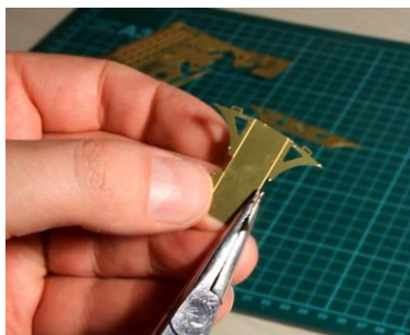
Mit Hilfe einer feinen Flachzange werden die Kesselauflagen um 90° gebogen. Plier à l'aide d'une pince fine de 90°.
