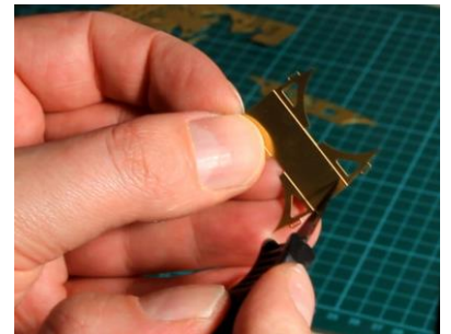
Die angeätzten Knicklinien liegen auf der Innenseite der Faltung! Les rainures photogravées se trouvent intérieur du pli!
