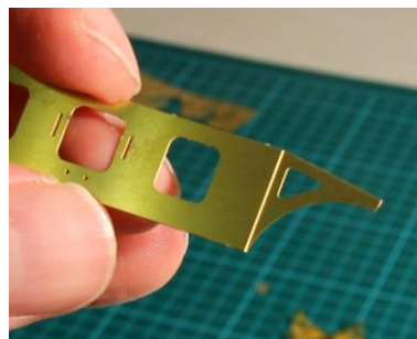
Knicklinien liegen innen! Les rainures photogravées côté intérieur.
