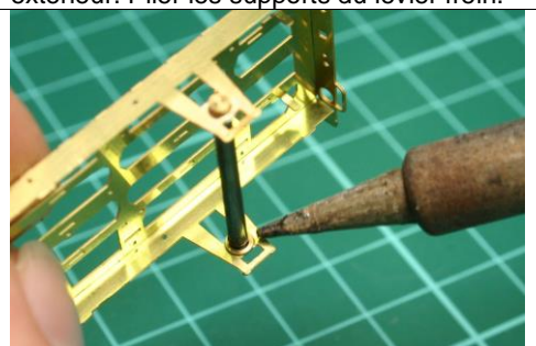
24. Achslager einlöten. Eine Achse ohne Räder hilft hierbei ! Souder les paliers pour les essieux avec un essieux sans roues pour stabiliser.
