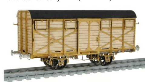
55. Dachhaut anfertigen : Dünner Karton (0,4mm), Maße 37,5mm x 95,0mm Toiture en carton fin : 37,5mm x 95,0mm
