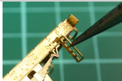
28. Kulisse für Handbremshebel in Rahmenseite einsetzen. Insérer la coulisse pour le levier de frein.
