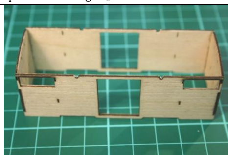
5. Gehäuseteile mit Sekundenkleber zusammenfügen. Assembler la caisse avec de la colle cyanoacrylate.
