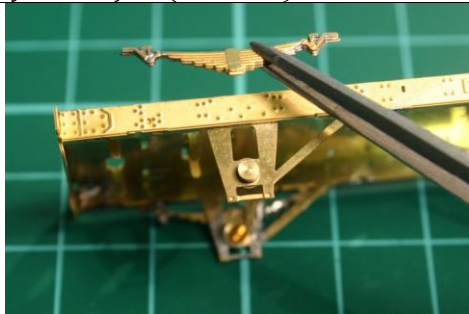
26. Die Federpakete werden am Rahmen angebracht. Insérer les ressorts au longeron.
