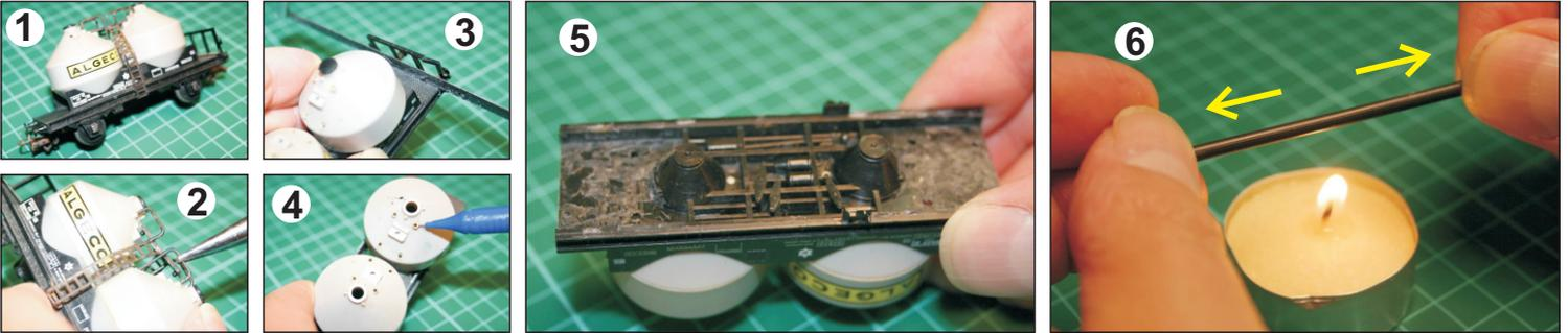
Le wagon est démonté (1 à 4) Le sous-châssis est fraisé pour y loger les attelages, freins et - si souhaité, comme dans cet exemple - supports d'essieux (5 + 20). Les mains montoires laissent des trous disgracieux (4), qu'on bouche facilement avec des chutes de plastique, qu'on mène au bon diamètre en les chauffant doucement (!!) sur une bougie
