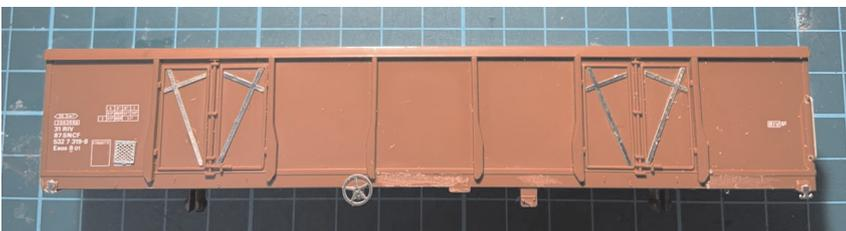
Aufbau: von links nach rechts: Anker (9), Zettelhalter (14), Türverstärkungen (10) (optional), Handbremsrad (11 und 12) (optional), Rangierergriffstange (13).
