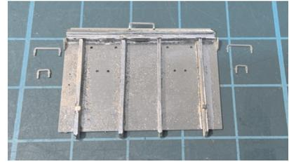
Stirnseite: An der Klappe (1) die obere Kante um 90° abwinkeln (geätzte Knicklinie innen), Scharniere ebenfalls abwinkeln. Den kleinen Griff nach oben um 90° abwinkeln.
