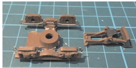
Klappe aufkleben. Pufferhalter (7) aufkleben (falls benötigt). Puffer nach Wahl einsetzen. Drehgestell: Bremsanlage (8) zurechtbiegen und im Drehgestell ankleben.
